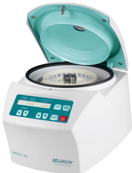
La MIKRO 185 è la più piccola fra le microcentrifughe di Hettich ed è ideale come una centrifuga personale per i ricercatori scientifici. La centrifuga ha una capacità di 24 provette di reazione.
